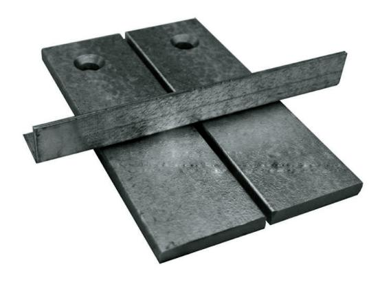
Zur Ausbildung und zum dauerhaften Schutz von Fugen in hochbeanspruchten Industrieböden oder für den Einsatz bei der Sanierung von Fugen in Industrieböden jeder Art. Mit doppelseitigem Kantenschutz aus unbehandeltem Stahl (optional aus verzinktem Stahl oder Edelstahl). Bohrung und Senkung für die Aufnahme von Befestigungsmitteln. Montagehilfen mit Einstellmöglichkeit auf die geforderte Fugenbreite.
